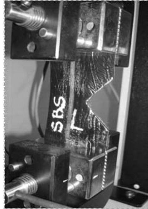
चित्र 3 – (अ) एपीपी नमूने पर तन्य शक्ति के परीक्षण का एक सामान्य दृश्य (ब) एसबीएस नमूने का टियर स्ट्रेन्थ मूल्यांकन के लिए टेस्ट प्रगति है
